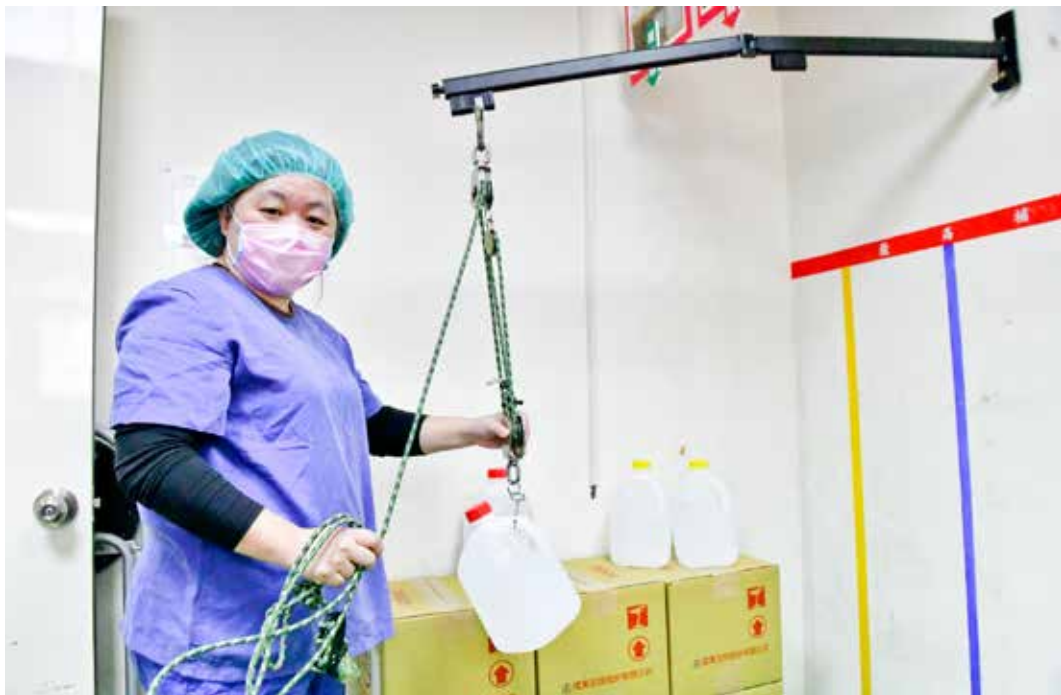
斗六慈濟醫院血液透析室張雅萍護理長以人因工程概念和滑輪設計出輸送裝置，降低護理師搬動洗腎輸液或消毒水的職業傷害。圖／斗六慈院提供
